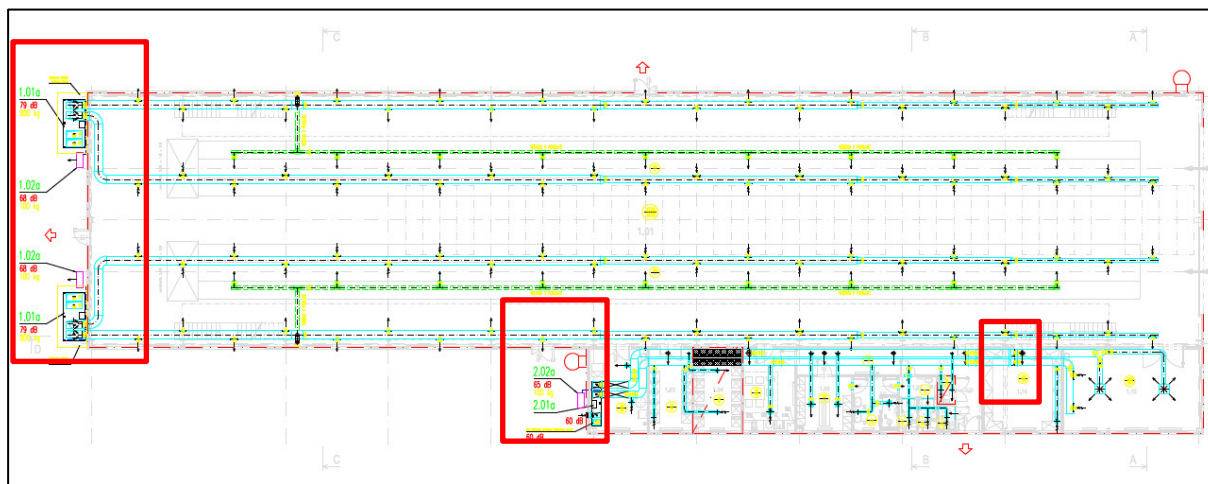
Obr. 3: Rozmístění stacionárních zdrojů hluku z pohledu celé budovy (červené rámečky v detailu níže)
